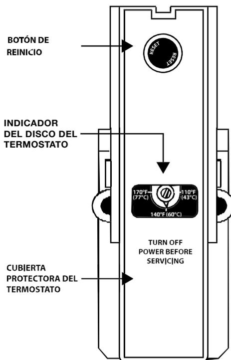
Este termo eléctrico está equipado con un termostato de hasta 170°F (77°C)
