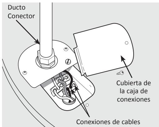
**Imagen conexión monofásica(220v)**
