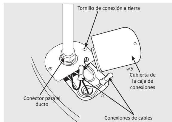
**Imagen conexión trifásica (380v)**
