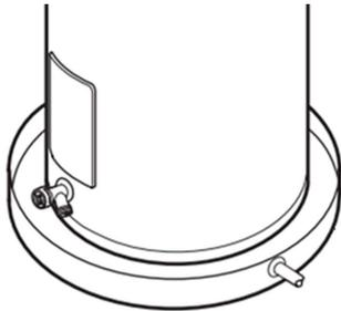
**AVISO:** Una bandeja de drenado auxiliar de 2" de profundidad puede ser colocada bajo el termo.
